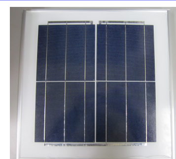
Fig.1 Mini PV module 400mm x 400mm, 6" p-Si 4 cells
