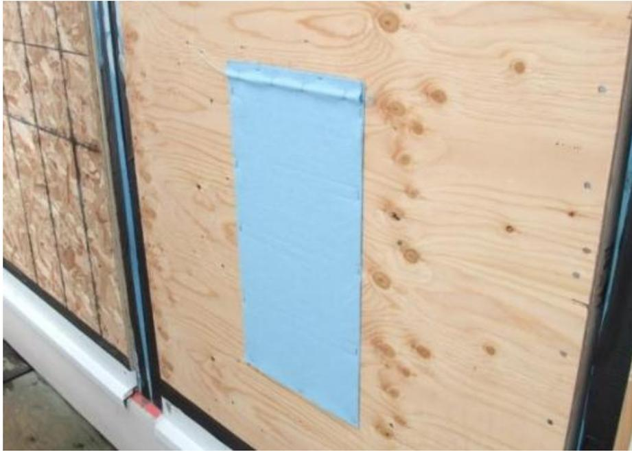
**Figure 27. Exterior wetting apparatus**
